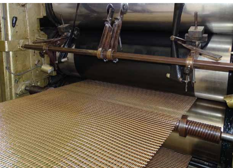
Fleximat® staalweefsel bewapening in het productieproces met EP-inlagen
